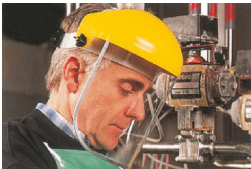
FIGURA 4.11 — Viseira de proteção em plástico transparente, com estrutura de suporte
